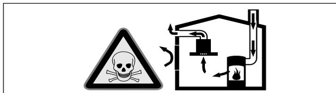
Εστίες, εξαρτημένες από τον αέρα του περιβάλλοντος (π.χ. συσκευές θέρμανσης που λειτουργούν με αέριο, λάδι, ξύλο ή άνθρακα, θερμοσίφωνες γκαζιού, θερμαντήρες νερού) λαμβάνουν τον αέρα για καύση από το χώρο τοποθέτησης και οδηγούν τα καυσαέρια μέσα από μια εγκατάσταση απαγωγής των καυσαερίων (π.χ. καμινάδα) στο εξωτερικό.
