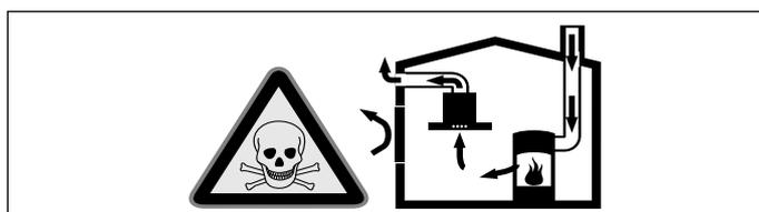
Equipamentos de aquecimento que dependem do ar ambiente (p. ex. sistemas de aquecimento a gás, óleo, lenha ou carvão, esquentadores, cilindros) utilizam o ar do espaço de montagem na combustão e transportam os gases de combustão para o exterior através do sistema de saída de gases de uma unidade de combustão (p. ex. uma chaminé).
